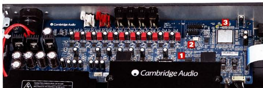
Wie die Zinnsoldaten: fünf Wolfson-Wandler (1) und zehn identische Audio-Ausgangsstufen (2) für den 7.1- und den Stereo-Ausgang; rechts der Upsampler (3) auf 24 Bit und 192 kHz
